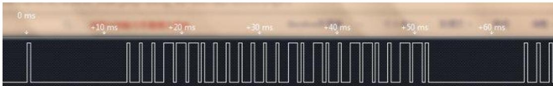
上面中间部分是一帧完整的数据，最有特征的就是最宽的部分，俗称同步脉冲，两个同步脉冲间的小脉冲是我们解的编码。你可以数一下，两个同步头间的高电平是 25bit，其中最后 1bit 是下一同步头的。我们只解其中的 24bit 即可
